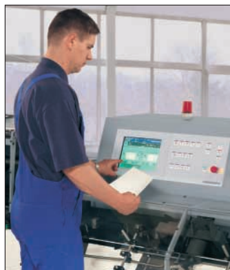
Am Berührungsbildschirm des Sammelhefters ST 400 sind alle Funktionen einstellbar.
